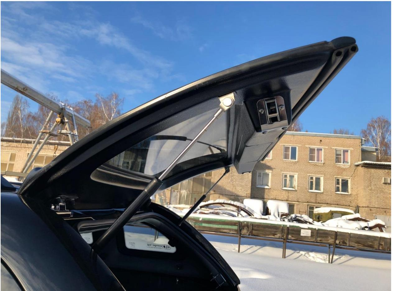
У кунгов марки ЕКО дверь более простой конструкции, нежели Avenger, но также намного прочнее аналогичных деталей кунгов других марок. Нижняя часть рамы сохранена, как и ее несущая функция при креплении фурнитуры. Через отверстия в стекле крепятся только верхние петли.
