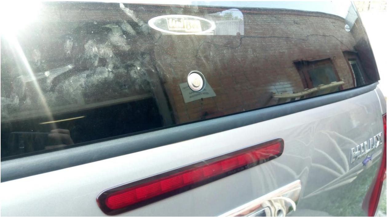
Дверь у TL-1 вообще не фиксирует борт пикапа. И если борт не закрыт ключом, то даже при запертом кунге возможен доступ в багажный отсек.
