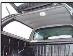
Новая внутренняя обшивка
