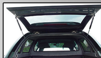
Усиленная рама задней двери кунга из стекловолокна
